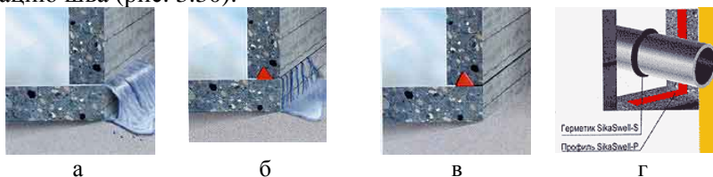
Рис. 3.30. Различные способы применения набухающих герметиков: а - увеличение в объеме разбухающего герметика; б - заполнение шва; в - установка гидрошпонки; г - проход коммуникаций
