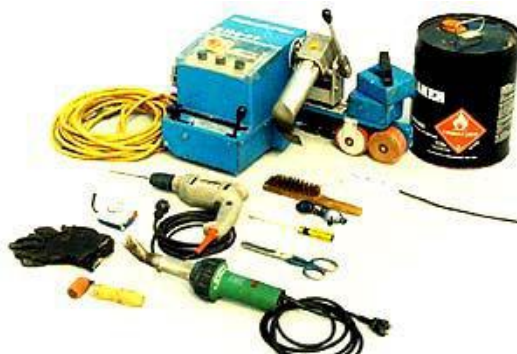
Рис. 10.2. Необходимые инструменты для соединения термопластичных мембран
