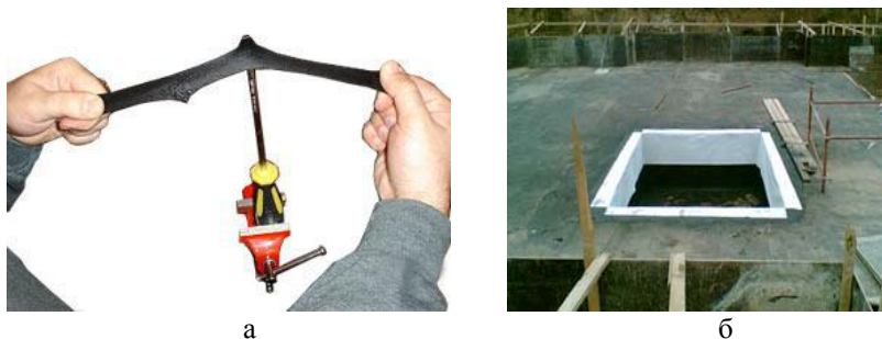
Рис. 6.1. Высокая растяжимость изделия из жидкой резины (а) и общий вид готового покрытия (б)
