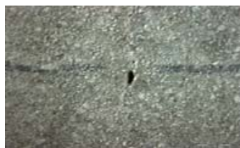
Рис. 9.2. Та же трещина через неделю нахождения в воде. Carat начинает затягивать трещину
