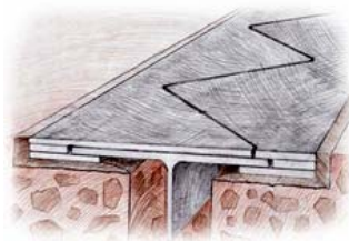
Рис. 3.17. Конструкция деформационных швов под высокую интенсивность движения
