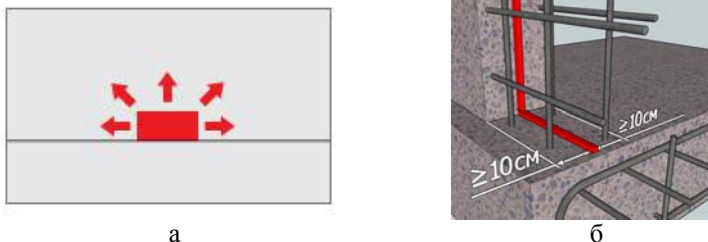
Рис. 3.26. Набухающий профиль: а - схема набухания профиля; б - монтаж профиля
