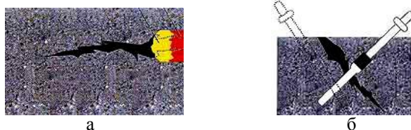
Рис. 3.35. Заполнение трещин в бетоне материалами фирмы Sika: а – заполнение трещин набухающим герметиком; б – установка инъекционных штуцеров
