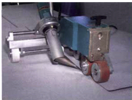
Рис. 10.6. Сварка швов термопластичной мембраны
